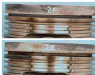
Minimální usazeniny na pístu po 500 hodinách testu Cat DEO-ULS.
