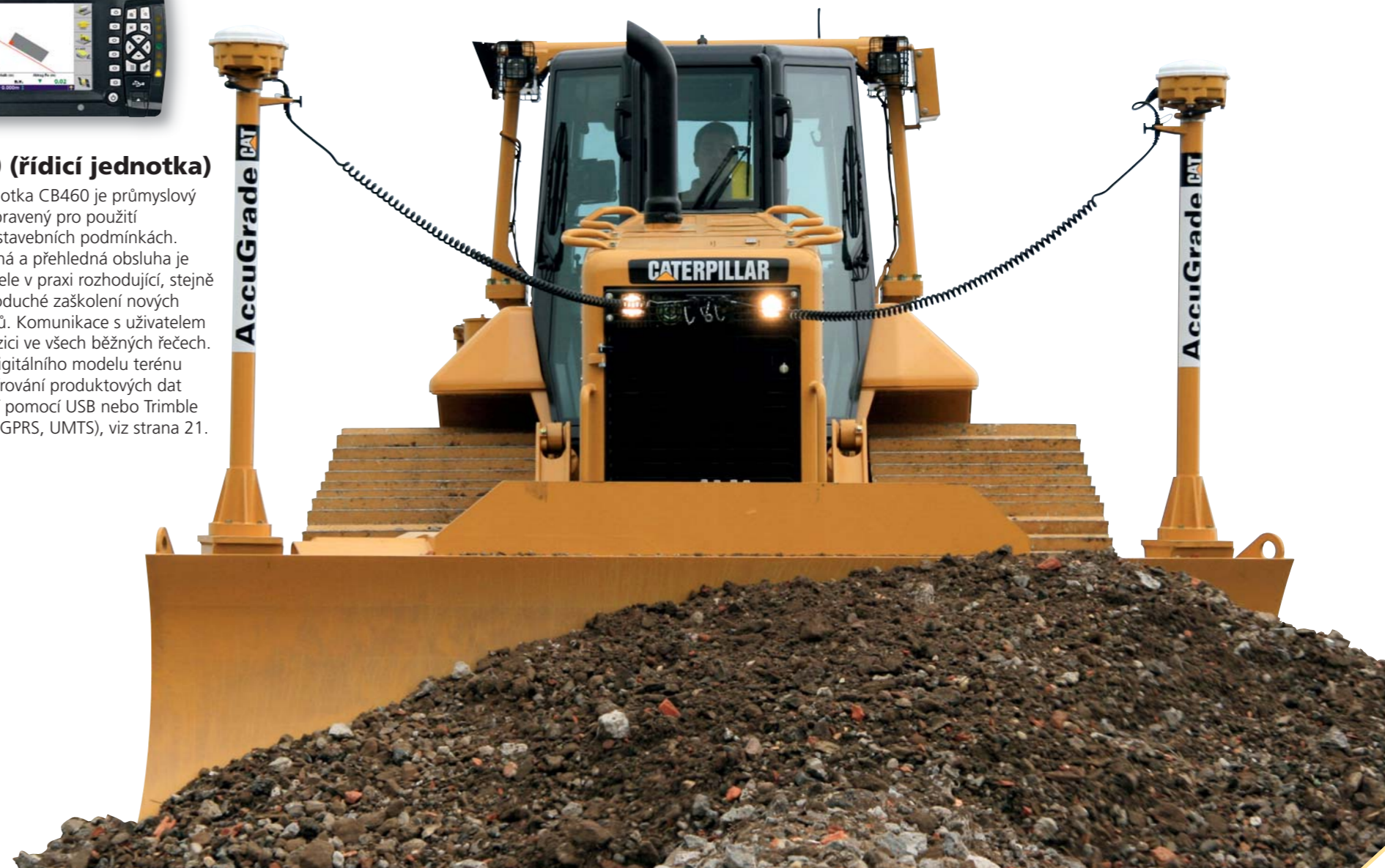
D6K LGP s duálním řízením GPS při svahování
