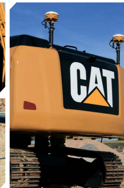
Přijímač MS992 GNSS (systém se dvěma GNSS anténami)
