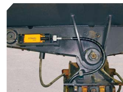
Kontrola sklonu svahovací lopaty úhlovým senzorem AS450 v robustním ochranném krytu z oceli
