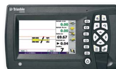
Řídicí jednotka CB450 je vybavena grafickým barevným displejem, integrovanými naváděcími diodovými lištami a intuitivními ovládacími klávesami
