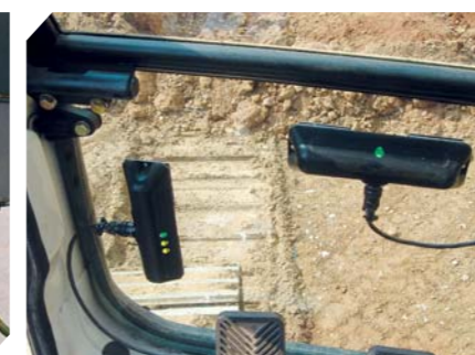
Světelná diodová lišta pro indikaci výkopulnásypu a rovněž pro určení linie a lomové hrany (volitelné)
